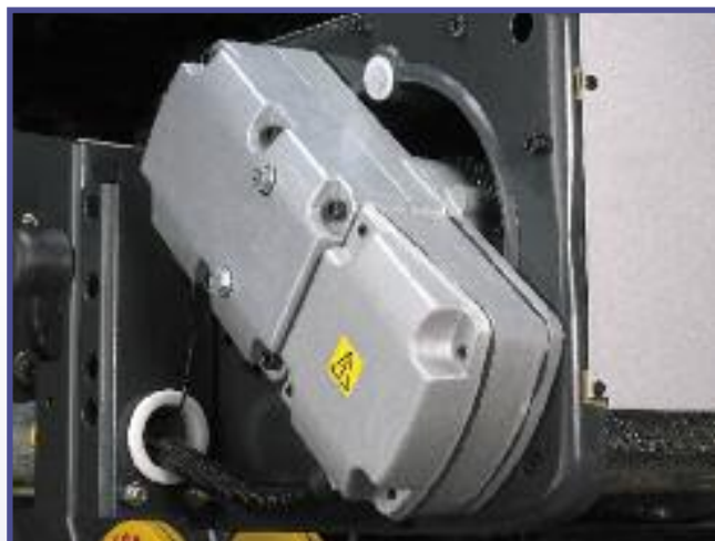
I riduttori di sollevamento sono molto silenziosi, di costruzione completamente chiusa in lega leggera verniciata a polvere ad alto spessore e lubrificati a vita per una manutenzione ridotta al minimo
