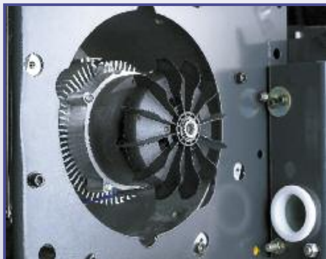
I freni di sollevamento sono del tipo a disco elettromagnetico, senza necessità di regolazione del traferro grazie alle dimensioni generose del magnete. La costruzione è chiusa antipolvere
